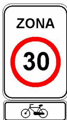
Figura 23. Senyal vertical en un carrer amb itinerari bici on hi ha coexistència bicis - vehicles motoritzats
